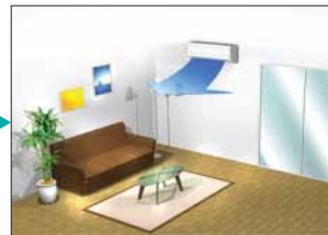
Khi Mắt thần dò tìm không có người chuyển động trong 20 phút, nó sẽ tự động tăng nhiệt độ lên 2°C.
