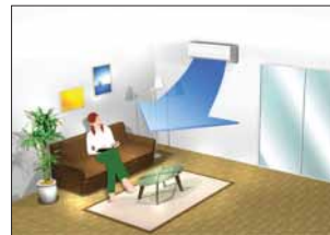
Khi có người trong phòng, máy lạnh sẽ hoạt động theo nhiệt độ cài đặt.
