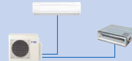
Hệ thống gồm 1 dàn nóng kết nối với 2 dàn lạnh
